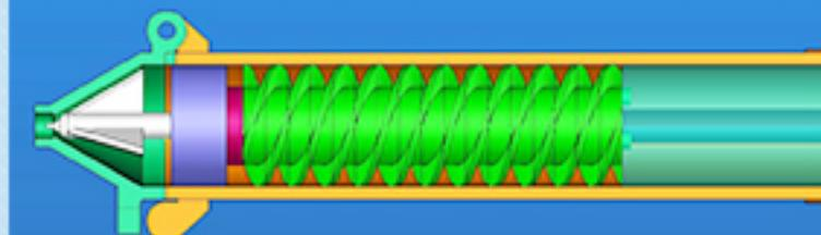
При подготовке машиной новой дозы корма, винт, вращаясь отодвигается, цилиндрическая камера наполняется смесью, которая проходит через полое фиолетовое кольцо и заполняет камеру впрыска.
