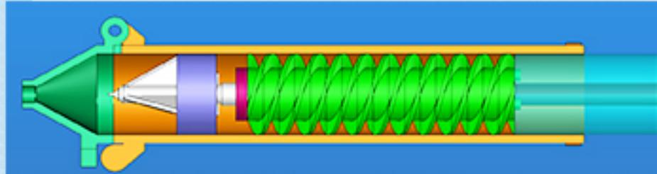
При нажатии на рычаг для подачи корма, винт плавно продвигается вперед, красное кольцо смыкается с фиолетовым для предотвращения проникновения смеси обратно в цилиндрическую камеру. Необходимая доза смеси выдается плавно и без рывка.
